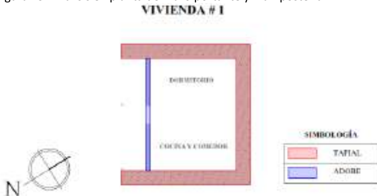
Figura 29. Análisis en planta de muro portante y mampostería.
